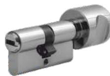
Freilauf-Profilzylinder mit Aufbohrschutz und Gefahrenfunktion einschließlich 6 Schlüsseln
